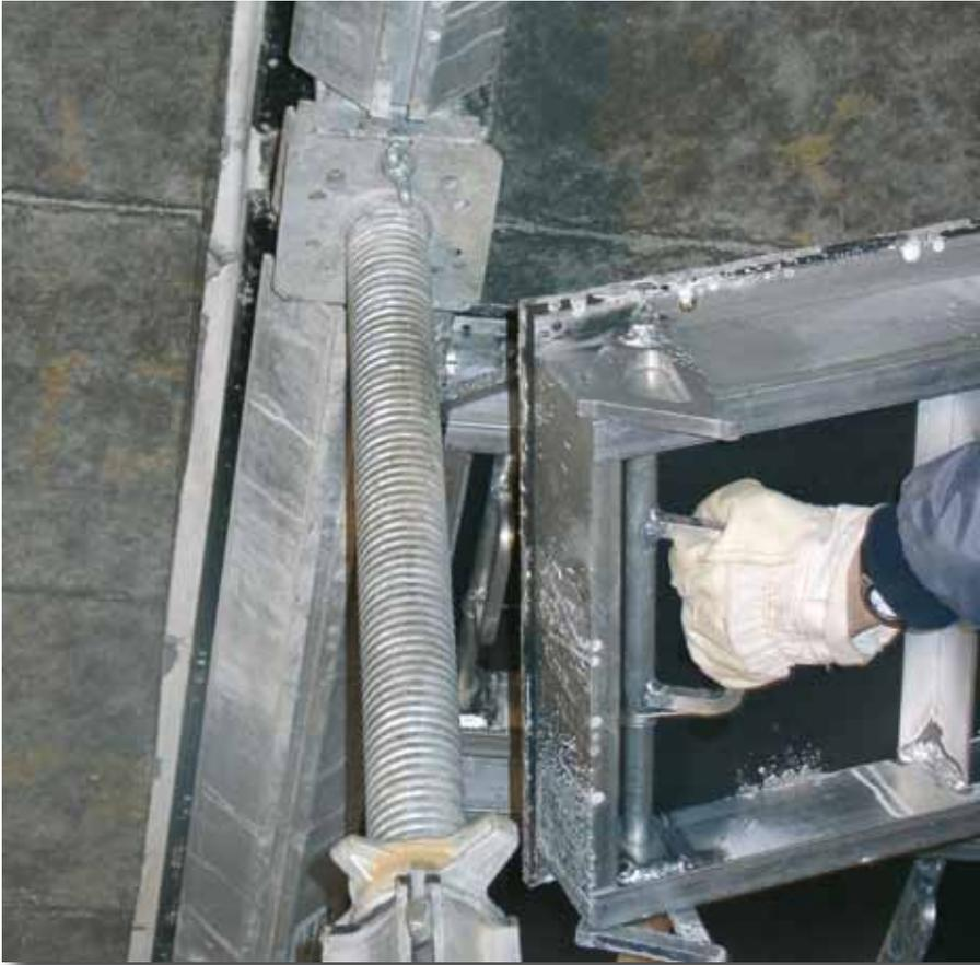
Ergonomisch günstige Griffposition und leichtes Ein- und Ausschalen durch Schwenklager an einer Seite
