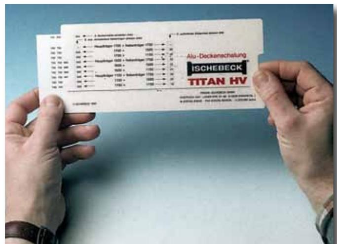
Zur bequemen Ermittlung der geeigneten Trägerkombination und der Stützensauswahl bei einer gewünschten Deckenstärke dient der Rechenschieber, den wir Ihnen gerne zusenden.
