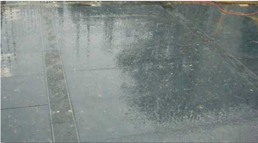
Massive GFK-Kunststoffplatte (keine Mehrschichtenplatte), gutes Betonbild, keine Wasseraufnahme, kein Quellen, gleich bleibende Biegesteifigkeit, weniger Trennmittel, leichter zu reinigen.
