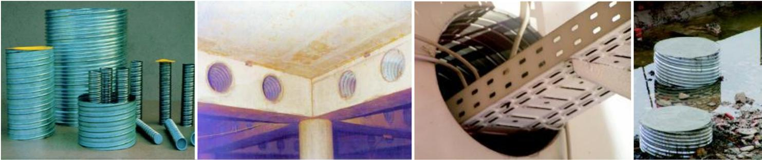
Das **MSL**-Aussparungsrohr ist ein linksgängiges und schraubenförmig gebogenes und gefalztes Wickelfalzrohr mit Verstärkungssicken von 2,5 mm bis 9 mm Sickenhöhe. Die Materialstärke der Rohre beträgt je nach Durchmesser 0,20 bis 0,75 mm.
